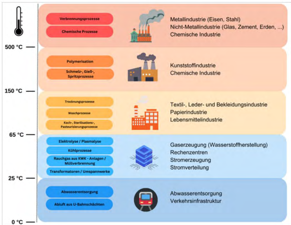
Abbildung 22: Temperaturniveau der Abwärme nach Industriezweigen Quelle: (Dunkelberg, 2023)
